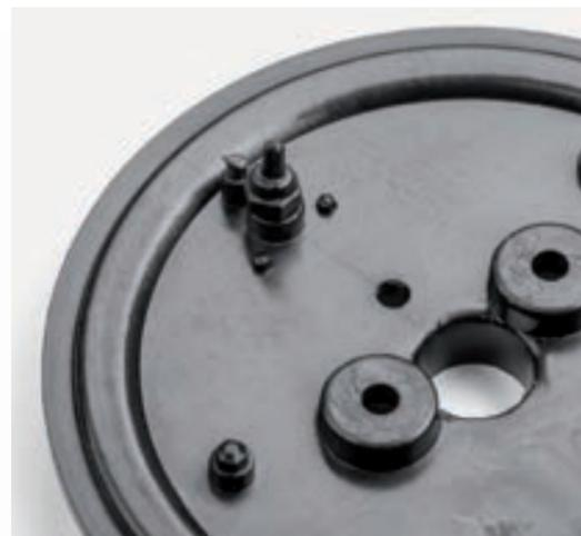
**Шаг 4.** Установите штуцер заднего тормозного цилиндра на тормозной щит заднего правого колеса. Обратите внимание: штуцер должен быть установлен в верхней части тормозного щита.
