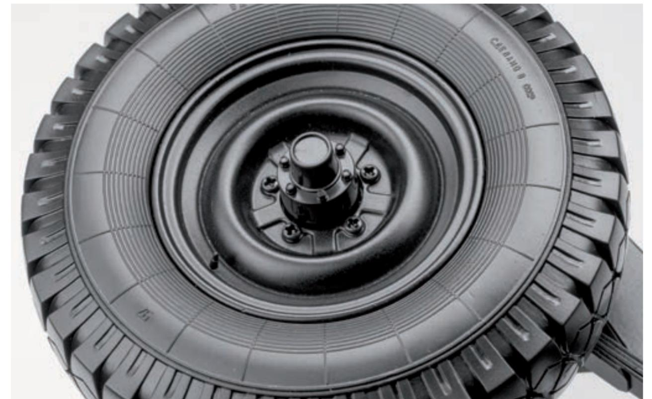
**Шаг 11.** Установите крышку поверх ступицы заднего правого колеса. Плотнo прижмите детали друг к другу. Крышка ступицы должна войти в центральное отверстие диска колеса.
