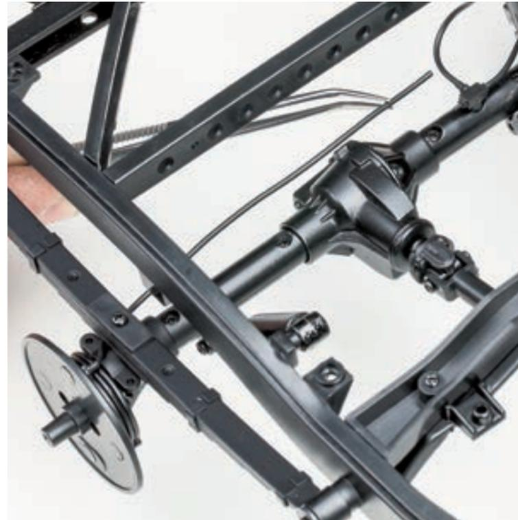
**Шаг 8.** Уложите трубку заднего правого тормоза между верхней частью кожуха полуоси заднего моста и рессорой. Закрепите свободный конец трубки на правом выходе тройника трубопровода к задним тормозам. При необходимости можно укоротить трубку.
