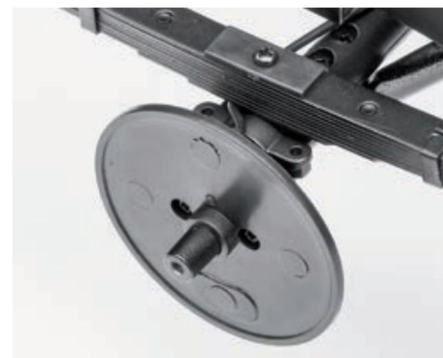
**Шаг 7.** Закрепите собранную крышку бортового редуктора на правом кожухе полуоси заднего моста. Для этого совместите крепежные отверстия деталей и зафиксируйте крышку бортового редуктора пятью винтами 2,0x4 (GM). Обратите внимание: для облегчения сборки в двух верхних отверстиях крышки редуктора уже присутствует резьба (на фото детали перевернуты).
